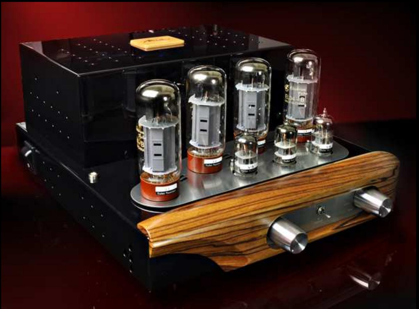
感謝您購買本站 Aria Myth 真空管綜合擴大機。本機由 EL34 做純 A 類超線性推挽線路，可以兼具三極管細緻與五極管大推力的優點。小信號管選擇 6n3/5670，市面上可供升級品種眾多，又容易取得。
